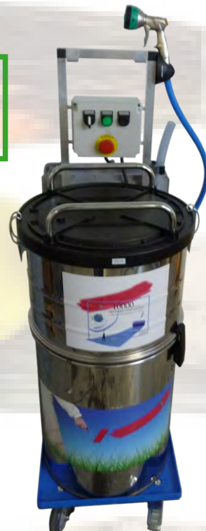
RCI 4 Station mobile de lavage automatique 4 outils
