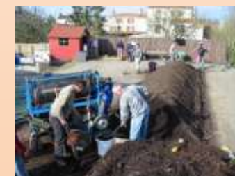
Le criblage mécanique du compost
